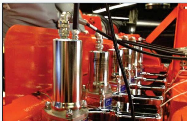
\*Высоковольтные катушки MOTORTECH с монтажным фланцем и с разъемом
