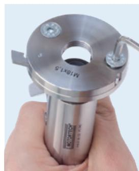
**2** Für die Aufnahme der einzustellenden Zündkerze stehen Gewintheadapter in unterschiedlichen Größen zur Verfügung (M14, M18, M22 oder 7/8-18 Zoll). Die Adapter lassen sich mit den enthaltenen Schrauben und dem Inbusschlüssel leicht montieren oder austauschen.
