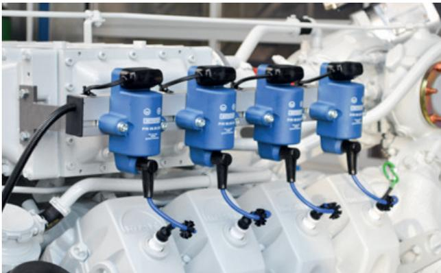
Schienenmontage am Ladeluftkühler
