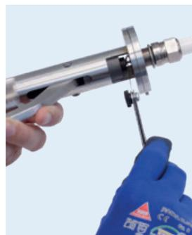
**4** Ein sanfter Druck des Hebels ist ausreichend, um den Elektrodenabstand mit Hilfe einer Fühlerlehre auf das gewünschte Maß einzustellen.
