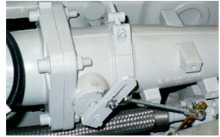
Auf Basis seines bewährten Designs bietet MOTORTECH eine spezielle Drosselklappe für die MAN®-Motorenbaureihen E2876 LE und E2842 E/LE an. Als Ersatz und Plug-and-Play-Lösung für das Original-Bauteil konzipiert, fügt sich diese Drosselklappe perfekt in den bestehenden Aufbau zwischen den Saugrohren nach dem Ladeluftkühler des Motors ein.
