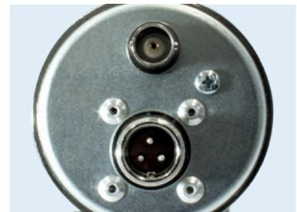
Zusätzlicher BNC-Anschluss für Hochspannungsmessung
