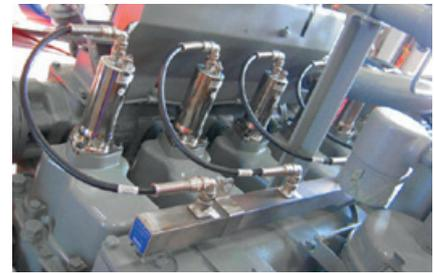
Verkabelungsschienenensätze für 12 Zylinder **WAUKESHA® VHP-ESM-Gasmotorenserien**
