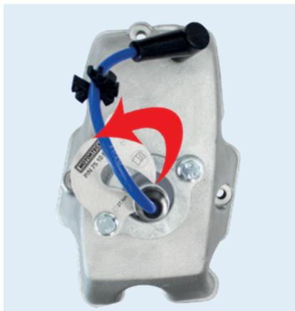
Zum Entriegeln der Zündleitung müssen beide Schrauben gelöst werden. Der Sicherungsflansch lässt sich nun auf der Flanschaufnahme des Ventildeckels zur Seite drehen.
