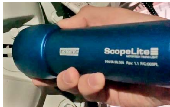
Определение угла опережения зажигания с помощью стробоскопа ScopeLite
