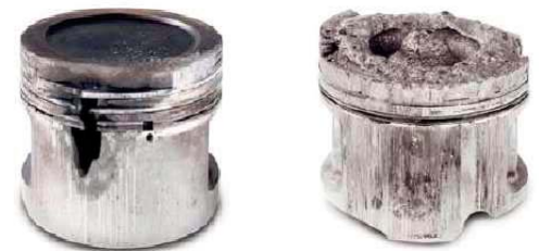
Поршни, вышедшие из строя в результате детонации
