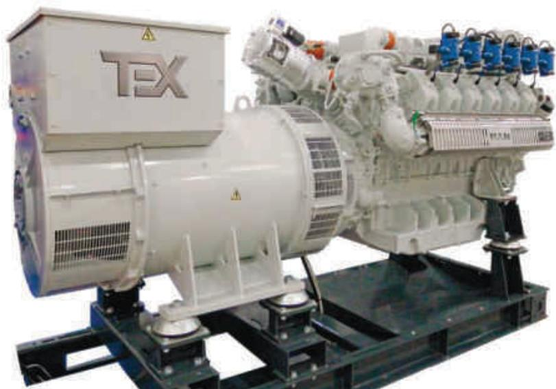
Немецкая инженерная школа (куда входят и австрийские компании) определенно рекомендует: на любые ДЭС и ГПЭС, предназначенные для непрерывной работы в течение длительного времени, следует ставить исключительно двухпорные генераторы, а соединение коленвала двигателя и вала ротора генератора следует выполнять посредством гибкой (упругой) резинометаллической муфты.
