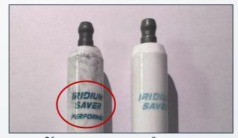
Обозначение на поддельной свече не соответствует типу свечи
