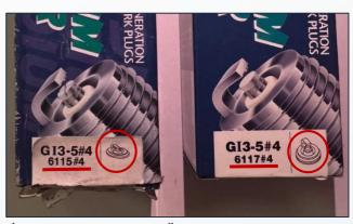
Фото электрода поддельной свечи не соответствует типу свечи. Шифр поддельной свечи не соответствует типу
