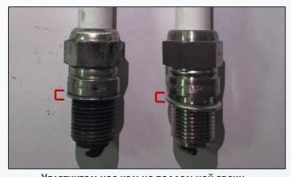
Уплотнительное кольцо поддельной свечи зажигания тоньше, чем у оригинальной
