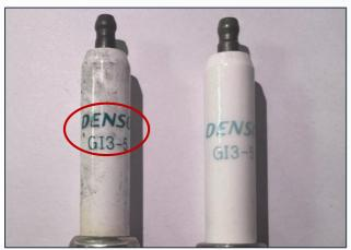
Тип нанесения маркировки на керамическом изоляторе у поддельной свечи - обычная печать, у оригинала - лазерное нанесение
