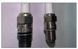
На металлическом корпусе поддельной свечи шрифт меньше, чем у оригинальной
