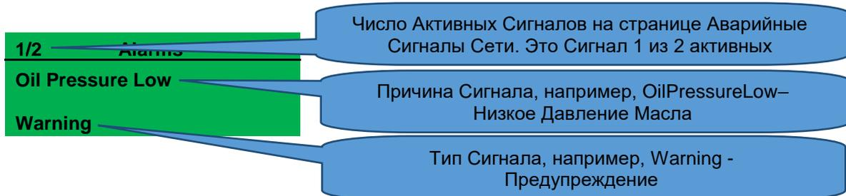
На ЖК-дисплее отображается несколько сигналов тревоги, таких как *“CoolantTemperatureHigh”* (*Высокая Температура Охл. Жидкости*), *“EmergencyStop”* (*Аварийная Остановка*) и *“LowCoolantWarning”* (*Предупреждение о Низком Уровне Охл. Жидкости*). Они автоматически
