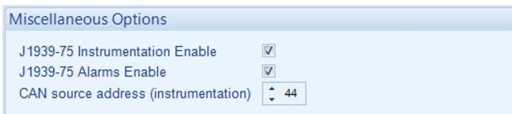
Примечание: MiscellaneousOptions – Прочие Параметры; InstrumentationEnable–Активировать Приборы; AlarmsEnable – Активировать Аварийные сигналы; CANSourceaddress (instrumentation) – Адрес Источника CAN (Приборы).
