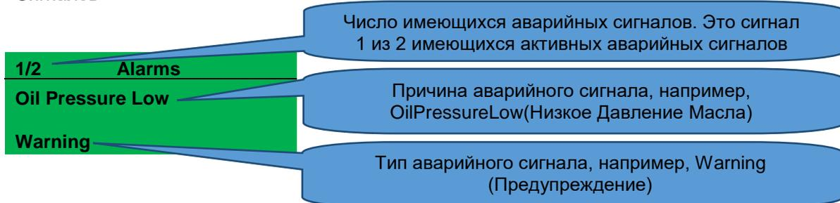
ЖКИ будет показывать несколько аварийных сигналов, например, "Высокая Температура Охл. Жидкости", "Аварийная Остановка" и "Предупреждение Низкий Уровень Охлаждителя". Они
