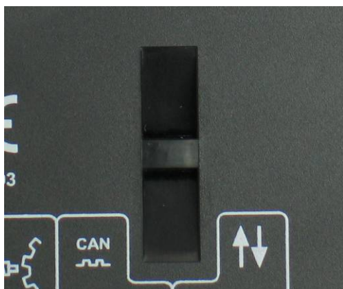
Точка крепления кабельной стяжки
